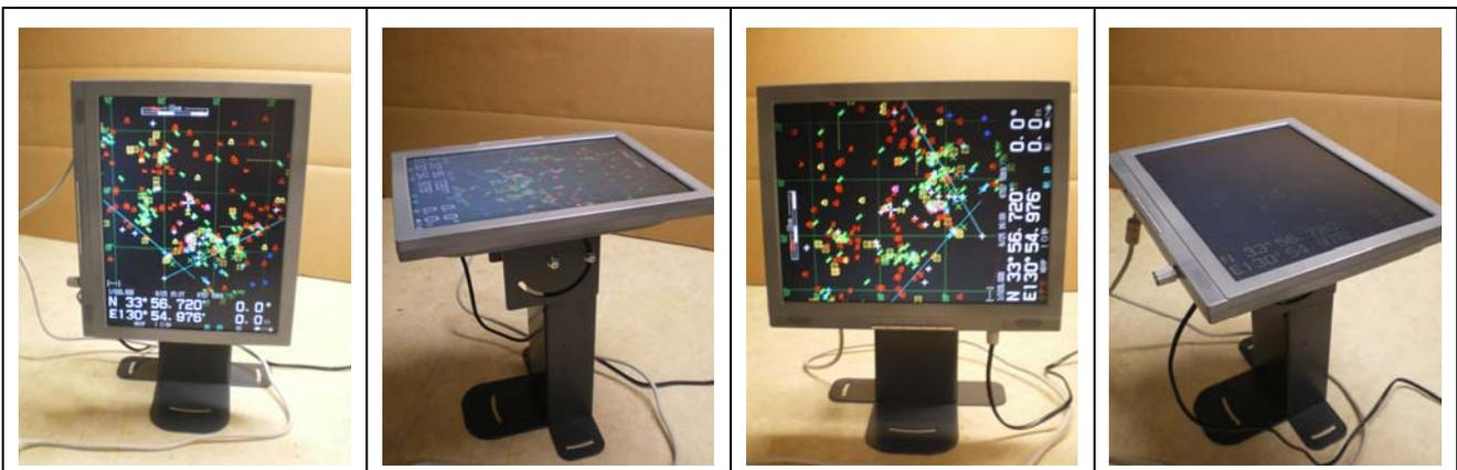
液晶モニターを縦方向/横方向に設置し上下方向に振った場合の画像
