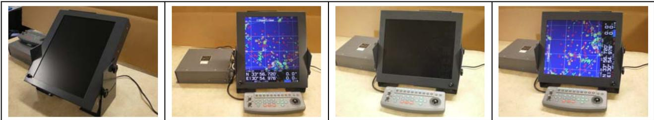
液晶ディスプレイを縦／横方向に設置し上下方向に振った場合の画像
